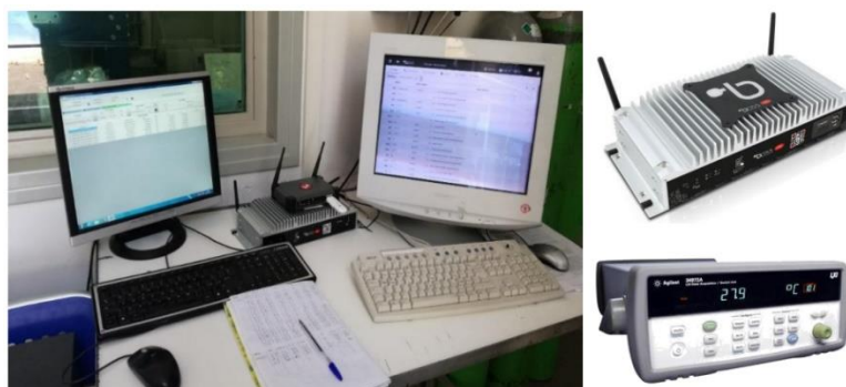
Figura 45. Sistema di acquisizione dati: Boss/Carel e DAQ Agilent
