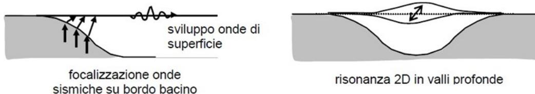
Figura 1.11 – Effetto di amplificazione sismica locale 2D, causato da fenomeni di diffrazione con generazione di onde superficiali ai bordi (Foti, Lai, & Rota, *Input sismico e stabilità geotecnica dei siti di costruzione*, 2009)
