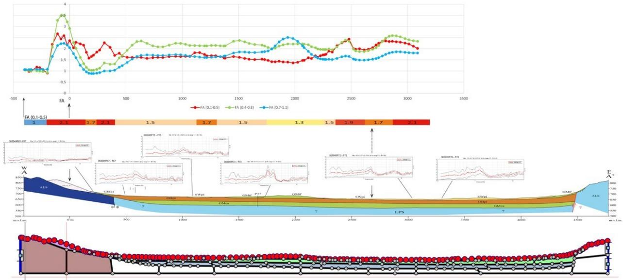
Figura 3.41 – Sezione geologica A-A' (unità classificate con legenda DPC) (al centro) con le progressive dei Fattori di amplificazione (in alto) e il modello in LSR2D (in basso).
