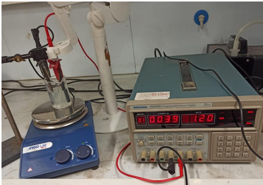
Figura 7.10 - foto dell'elettrodeposizione svolta in laboratorio.
