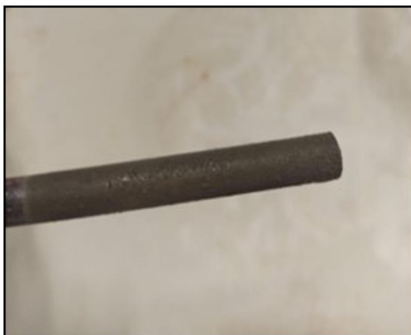
Figura 7.13 - catodo ricoperto di argento.
