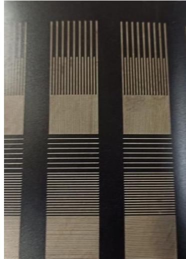
Figura 7.15 - foto del circuito stampato dopo lisciviazione.
