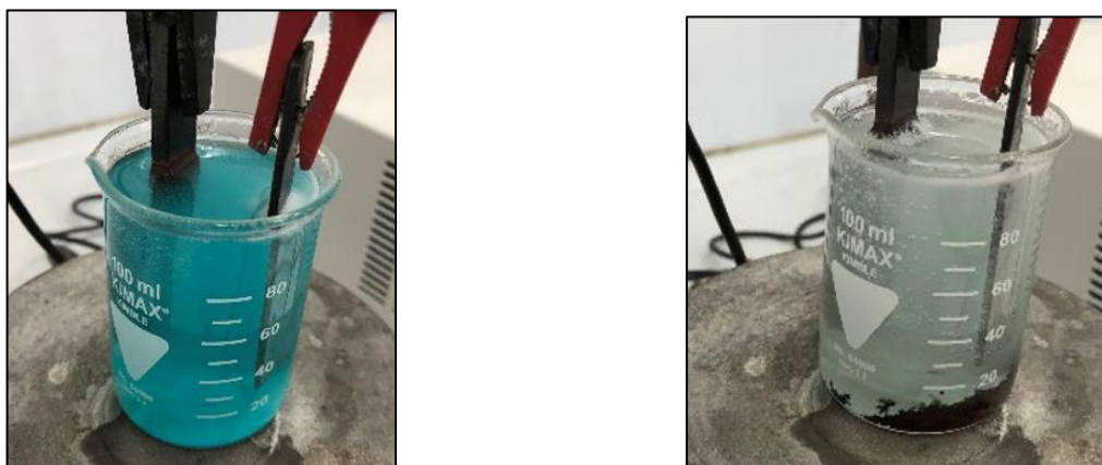
Figura 6.8: Recupero di rame dall'elettrodeposizione (all'inizio e alla fine del test)
