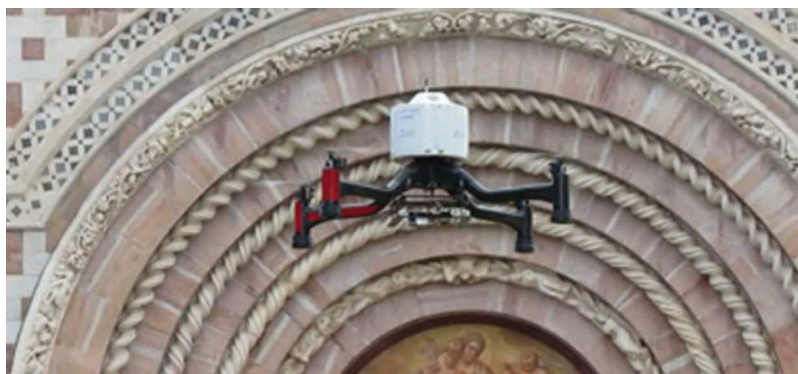
Figure 11. Survey with a UAV system of the Basilica di Collemaggio.
