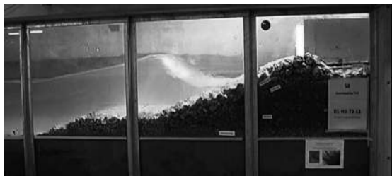
Figura 1. Modello fisico di opera a gettata con berma sommersa.
