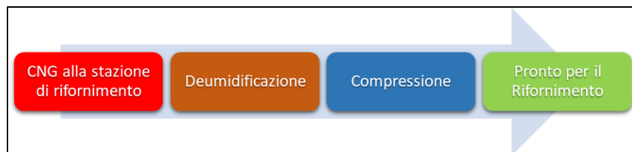
Fig.2.13 - Tipico workflow per il rifornimento del CNG a bordo veicolo.
