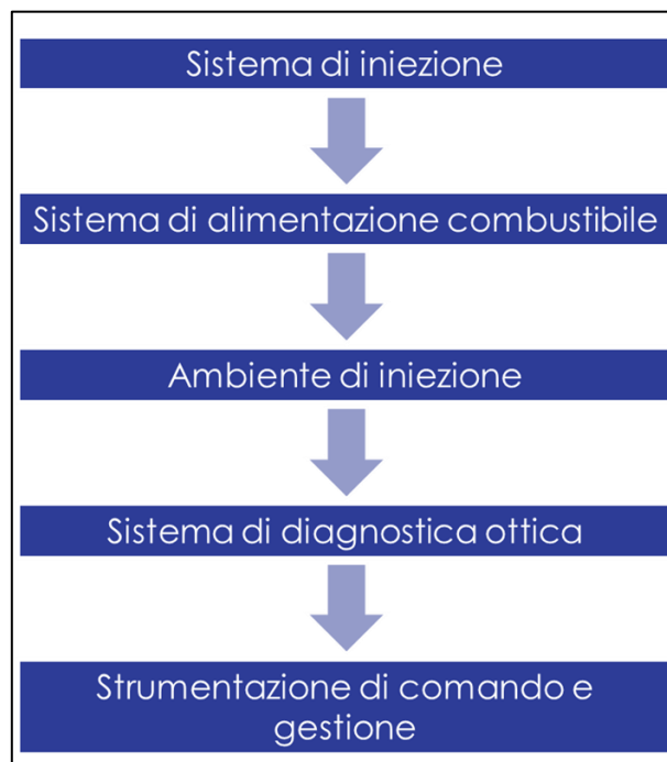
Fig.3.22 - Workflow per l'allestimento di un apparato sperimentale per la caratterizzazione di uno spray.
