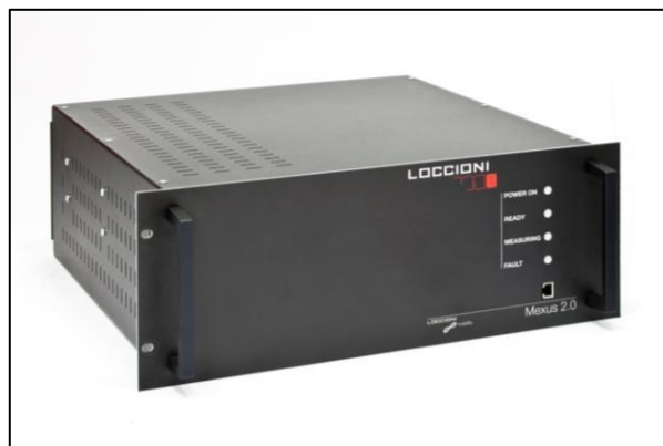
Fig.7.9 - Rack contenente la componentistica hardware deputata al controllo del misuratore di portata.
